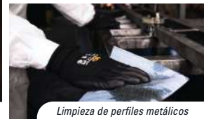
Limpieza de perfiles metálicos
